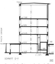
Querschnitt Längstrakt durch Festsaal | Coupe de l'aile basse (salle de fête) | Cross-section through low wing (banquet hall)
