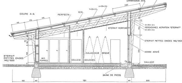
Coupe transversale des vestiaires 1:100 | Querschnitt durch den Garderobenbau|Cross section of dressingroom building
