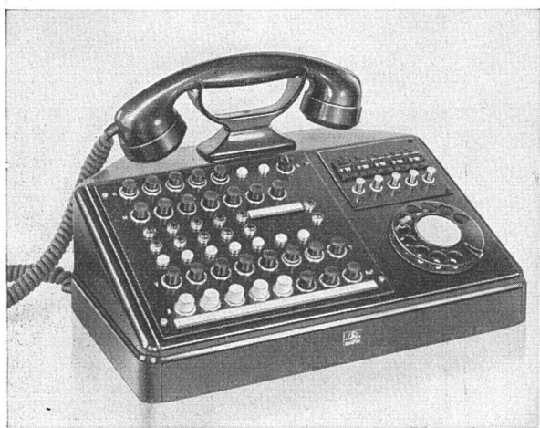
Vermittlungsstation für Telephonanlagen mit 5 Amtsleitungen.
