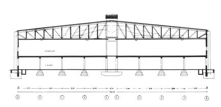
Querschnitt durch Maschinenhalle 1:500. Künstliche Belichtung und Belüftung. Fensterband auf Augenhöhe gibt Blick ins Freie | Coupe transversale. Eclairage et aération artificiels | Cross-section of weaving hall. Artificial lighting and ventilation
