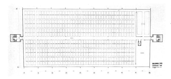
Großer Webmaschinensaal im Obergeschoß  $100 \times 50$  m, 1:1000 | Grande salle de tissage au premier étage | The weaving hall on upper floor  $300 \times 150$  feet wide
