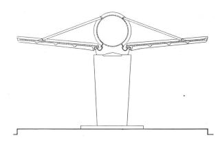
Querschnitt 1:100. Der Rohrträger ist begehbar und enthält die elektri schen Leitungen, die durch die Aufhängungen der Dachplatten zu de. Signalen geführt werden | Coupe. Le tube, dans lequel on peut s déplacer, renferme fils électriques | Cross-section. The tubular girder are accessible and contain the electric cables
