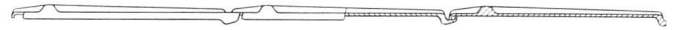
Längsschnitt 1:100 durch die vorfabrizierten Beton-Dachplatten, die sich wie Falzziegel überdecken | Coupe longitudinale des plaques de béton du toit se couvrant l'une l'autre comme des tuiles | Longitudinal section through the pre-fabricated concrete roof slabs which overlap each other like fluted tiles
