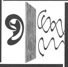
Der Trittschallschutz ist um so größer, je elastischer der Bodenbelag ist; denn indem der Trittschall schon im Augenblick des Entstehens erfaßt wird, ist seine Entfaltung verhindert. Man sagt nicht vergeblich, Gummi «verschlucke» den Lärm.
