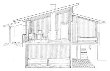
Abb. 12 Das Erdgeschoβ wird zum Dachraum, in dem die Höhen der Raumbedeutung entsprechend abgestuft sind
