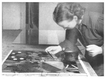
7 Aufwachsen der Glasstücke mittels Wachstropfen | Assemblés sur une plaque de verre simple, les morceaux de verre y sont fixés avec de la cire  $liquide \mid The \ pieces \ of \ glass, fixed \ with \ wax, \ are \ assembled \ on \ plain \ glass$
