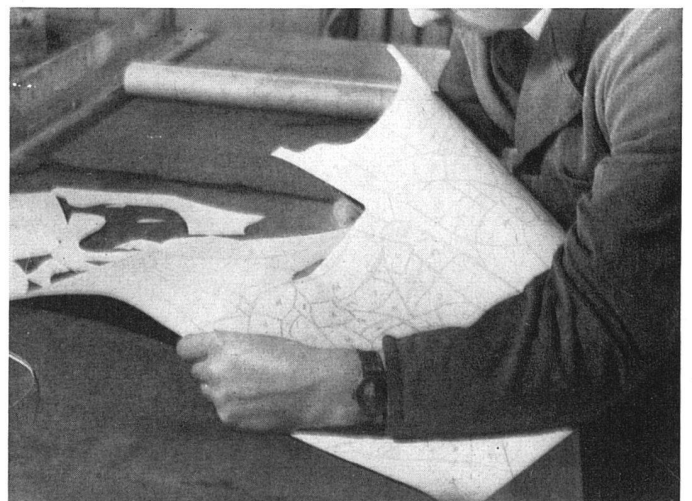
3 Schneiden der Schablonenstücke aus steifem Papier | Découpage du pochoir | Cutting of pattern
