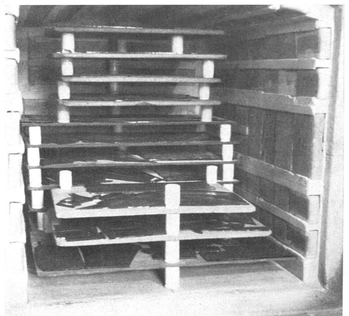
9 Die Glasstücke auf Platten im Ofen | Les morceaux de verre peints à la grisaille passent au four | The pieces of painted glass in the oven
