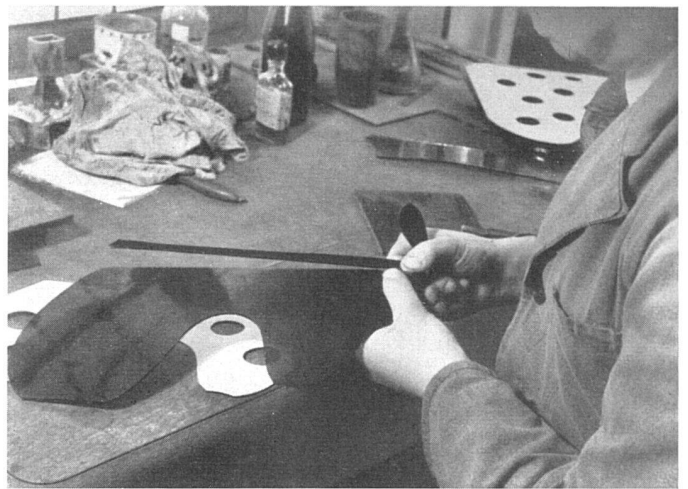
5 Brechen des geschnittenen Glases | Rupture à la main du verre précédemment entamé par une coupe droite au diamant | The glass is broken by hand after previous cutting by diamond
