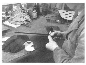
5 Brechen des geschnittenen Glases | Rupture à la main du verre pré $c\'edemment\ entam\'e\ par\ une\ coupe\ droite\ au\ diamant\ |\ The\ glass\ is\ broken$ by hand after previous cutting by diamond
