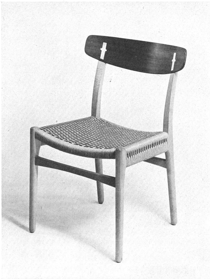
Eßzimmerstuhl. Rückenlehne Teakholz, Rahmen Buche, Sitz aus Papierschmurgeflecht. Entwurf H. J. Wegner, Ausführung C. Hansen & Sohn, Odensee | Chaise de salle à manger | Diningroom chair, back of teak, frame of beech, seat of paper cords
