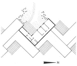
Abb. 16. Projekt für Siedlungshäuser zick-zackartig zusammengebaut in Hölles, Österr., Architekt Anton Brenner | Projet pour maisons de colonie en zigzag. | Project for attached zigzag houses
