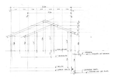
Verschiedene Wandhöhen und einheitliche Dachneigung ergeben die Haus- und Raumprofile | Le profil des maisons et des pièces résulte de la hauteur différente des murs et de la pente uniforme des toits | The profiles of house and space are produced by varying wall-heights and unified roof inclination
