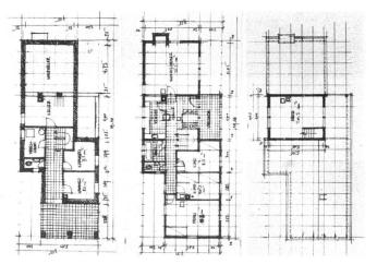
Der Grundriß entsteht über einem Raster, der durch die gewünschten Raumgrößen und die Pfostenabstände des Fachwerks bestimmt wird | La plan naît d'un schéma quadrillé, déterminé lui-même par la grandeur voulue des pièces et l'écartement des poutres de la charpente | The groundplan grows up above a screen determined by the sizes of the rooms desired and the distances between the posts of the timber-framing
