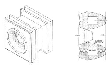
Ansicht und Schnitt 1:15 der vorfabrizierten Betonelemente mit eingekittetem rundem Glaskörper | Eléments de béton préfabriqués et vitrés | Prefabricated and glazed concrete elements
