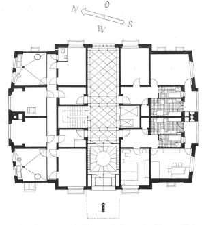
Erdgeschoβ 1:300 mit Eingangshalle, zwei 2-Zimmer-Wohnungen, zwei Waschküchen, zwei Trockenräumen, Zentrale der Kühlschränke | Rez-de-chaussée avec hall d'entrée, deux buanderies, deux séchoirs | Groundfloor plan with entrance hall, two laundries, two drying rooms
