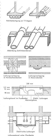
In Rohrkanälen elektrische Leitungen von den übrigen trennen!
