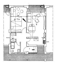
Typischer Wohnungsgrundriß 1:200. Die Wohnung liegt zur besseren Absonderung 3 Stufen höher als der Laubengang | Plan-type d'un apartement de 2 pièces | Typical plan of two room apartment
