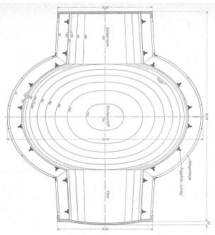
Abb.1. Felix-und-Regula-Kirche, Zürich. Fritz Metzger, Arch.BSA. Untersicht der Deckenschale 1:300, Niveaukurven mit 30 cm Aequidistanz | Le plafond à voile mince vu d'en bas, équidistance des courbes de niveau: 30 cm | The ceiling in shell construction seen from below
