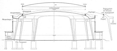
Abb. 2. Querschnitt durch die Kirche 1:300, Spannweite der Schale 24 m, Scheitelhöhe 1,6 m | Coupe transversale; portée de la coupole à voile mince 24 m, hauteur au sommet 1.60 m. | Cross section, the span of the shell dome is of 72 feet and its height 5 feet 4"
