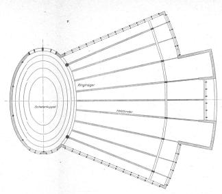
Abb. 4. St.-Franziskus-Kirche in Riehen. Fritz Metzger, Arch. BSA. Untersicht der Kirchendecke 1:300. Schale über Chor durch Niveaukurven angedeutet, radial angeordnete hötzerne Dachbinder | Le plafond vu d'en bas; coupole à voile mince sur le chœur, sommiers en bois au-dessus la nef | The ceiling seen from below; shell dome over altar space, wooden girders over nave
