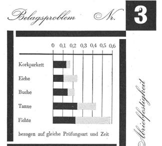
Der stärkst beanspruchte Teil des Innenausbaus ist der Bodenbelag. Abrieb und Druckfestigkeit bestimmen Lebensdauer und Aussehen des Belages. Kein Wunder, daß Hartholzbeläge als unübertroffen galten.
