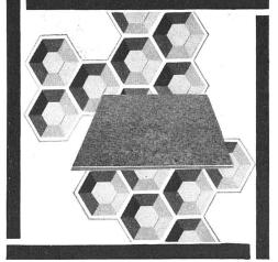
Ob ein Belag fußwarm ist, hängt davon ab, wie rasch er die Fußwärme ableitet. Entscheidend dafür ist seine innere Struktur. So wird ein massiger Belag mehr Wärme ableiten und weniger fußwarm sein als ein zellular aufgebauter Belag.
