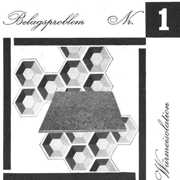
Ob ein Belag fußwarm ist, hängt davon ab, wie rasch er die Fußwärme ableitet. Entscheidend dafür ist seine innere Struktur. So wird ein massiger Belag mehr Wärme ableiten und weniger fußwarm sein als ein zellular aufgebauter Belag.
