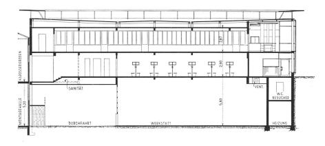
Längsschnitt des Zentralgebäudes 1:300 | Section longitudinale du bâtiment central | Longitudinal section of central building
