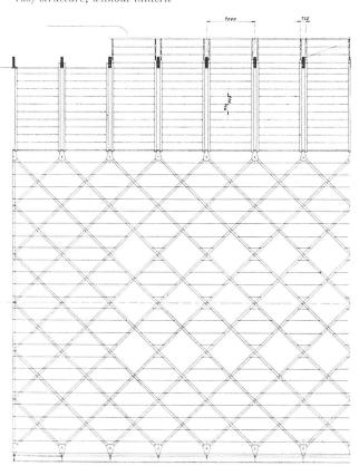
$St\"{a}nder\ mit\ verschwei\beta ten\ Bogenst\"{u}cken\ |\ Piliers\ avec\ les\ tronçons\ d'arc\ soud\'{e}s\ |\ Stanchions\ with\ welded\ arch\ sections$
