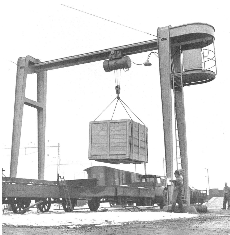
Der Kran mit 10-Tonnen-Katze in Arbeitsstellung / La grue à portique avec treuil en position de travail / Crane with ten-ton crab in operation
