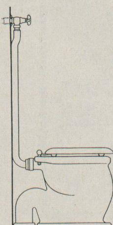
Der kurzgebaute **KWC**-Spülhahn soll bisherige Modelle mit unpraktisch großer Auskragung ersetzen.
