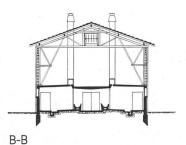
Querschnitt durch Stall und Heubühne | Coupe de l'étable et du fenil | Cross section through cow-shed and hayloft
