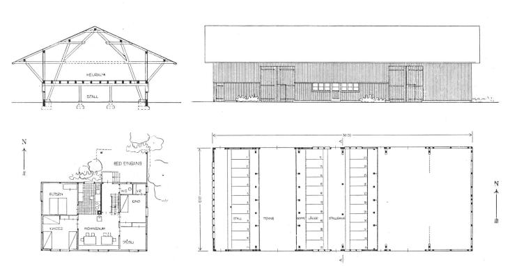
$Wohnhaus\ und\ Scheune\ des\ Siedlungsgebietes\ {\it ``lles}\ de\ Sion",\ Wallis.\ Grundrisse,\ Schnitt,\ Fassade\ 1:300\ |\ Plans,\ coupes\ et\ façade\ |\ Ground-floor\ plans,\ cross-section\ and\ elevation$
