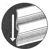
Bei geschlossenem Storen überschneiden sich die S-förmigen Lamellen
