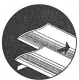
Diese Schrägstellung der S-förmigen Lamellen bricht die Sonnenstrahlen und ergibt gleichmäßige, indirekte Beleuchtung
