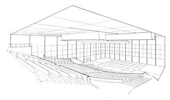
richtungen wird es möglich, den Theaterraum je nach Aufführungsart mit wenigen Manipulationen vollständig zu verändern. Die ansteigende Zuschauertribüne ist so angeordnet, daß bei jeder Aufführungsart von allen Plätzen gute Sicht gewährleistet ist.
