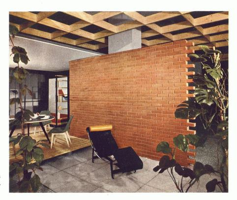
Sichtmauerwerk mit Normal-Backsteinen 25/12/6 cm, aus dem Tonwerk Döttingen, der A.G. Hunziker & Cie.
