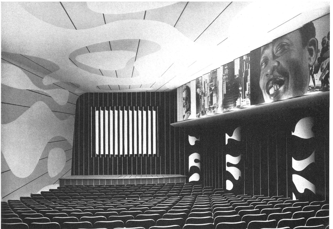
Blick gegen Bildfläche, aus drehbaren Jalousien bestehend, Rückseite schwarz, Vorderseite weiß, in halb gedrehtem Zustand | L'écran se compose de lamelles pivotantes dont une face est noire et l'autre blanche | Screen consisting of rotatory blinds. Back black; front white, half rotated
