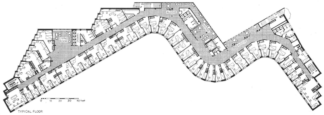
Obergeschoß 1:700 | Etage supérieure type. La forme sinueuse assure aux unités d'habitation une grande individualité et une exposition sud malgré l'exiguïté du terrain | Upper storey
