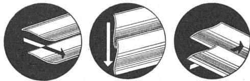
Die patentierten S-förmigen Lamellen der KIRSCH Sun Air-Storen gewähren ein idealeres Abschirmen der direkten, blendenden Sonnenbestrahlung, unter gleichzeitiger Schaffung günstiger Licht- und Temperaturverhältnisse.
