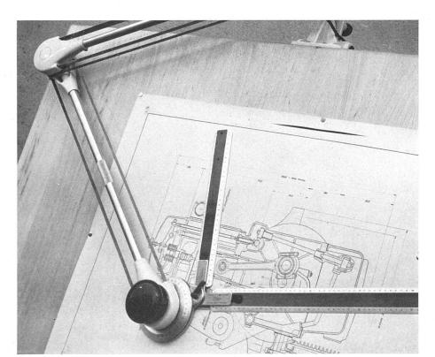
Präzisions-Zeichenmaschine. Leicht zu handhaben, Parallelführung vermittels Stahlbändern. Hersteller: O. Key AG., Zürich. Vertrieb: Ozalid AG., Zürich / Machine à dessiner; beauté des articulations / Precision drawing-machine, easy to handle, steel-ribbon guides
