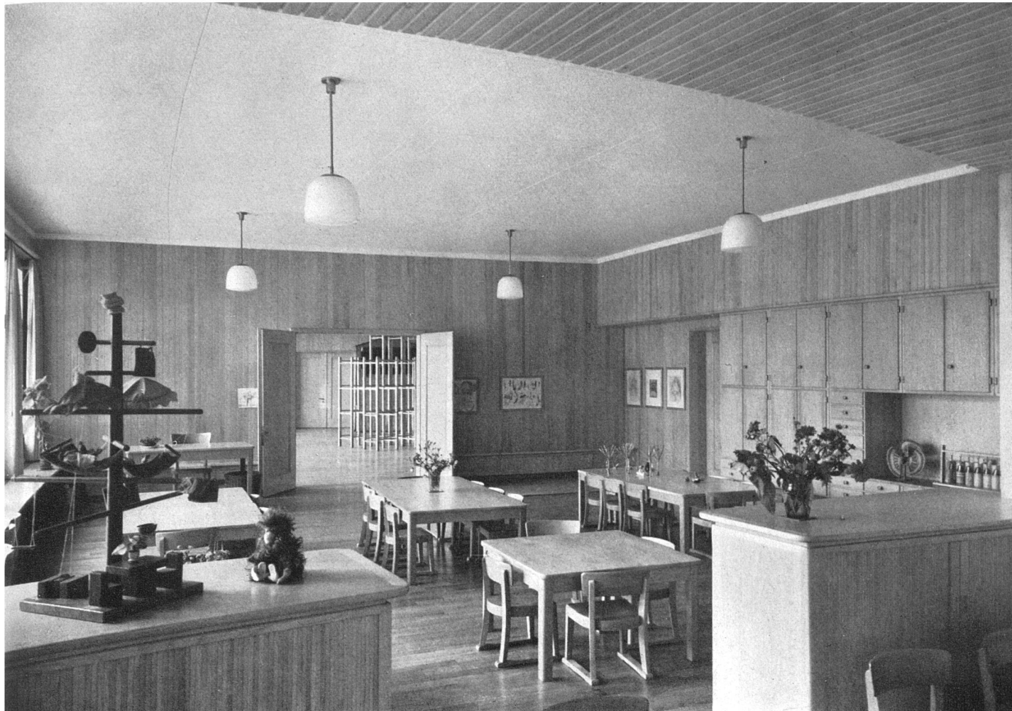
Hauptlokal mit Doppeltüre nach der Spielhalle. Bodenbelag Eichenriemen, Wände Tannentäfer, Möbel aus gedämpftem Buchenholz / Salle principale; la double porte donne sur le préau. Parquet de chêne, parois en sapin, meubles en hêtre / Main room with double doors opening to the play-hall. Floor of oak strips, walls of pine-boarding, furniture of beech wood
