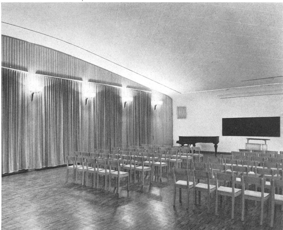
Singsaal bei Nacht. Decke aus Pavatex-platten in Naturton gestrichen / Salle de musique; plafond en «Pavatex» peint en couleur naturelle / Music room with «Pavatex» fibre board ceiling finished with clear varnish
