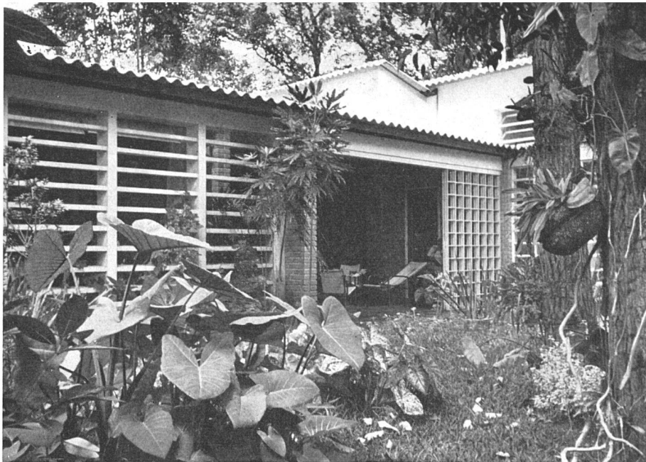
Gartenhof mit Blick auf Veranda und Wohnraum, links feste Jalousien aus Eisenbeton / La grande salle s'ouvre sur la cour par une grande porte coulissante, à gauche, brise-soleil en béton armé / Large sliding door between living room and garden courtyard, at left louvers made of concrete
