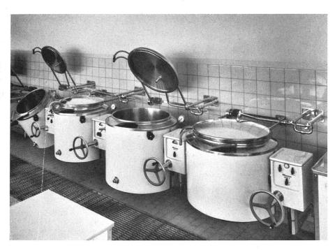
(von l. n. r.) Elektroden-Kippkessel, rechts Kippkessel mit Strahlungsheizung | (de g. à dr.) Groupe de marmites pivotantes | (from l. to r.) Group of tilting pans
