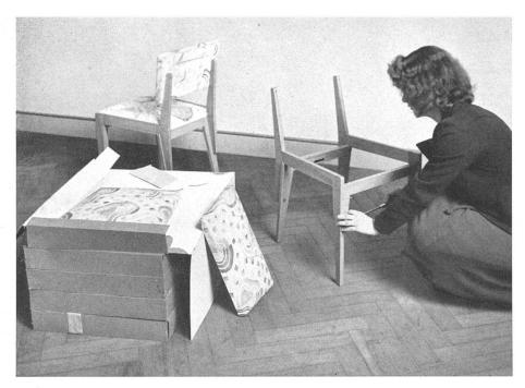
Die in einem soliden Paket gelieferten Stühle werden in der Wohnung auf einfache Weise zusammengesetzt. Geringer Platzbedarf für die Lagerung großer Serien, Schutz beim Transport /
