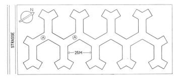
Bebauung mit Zeilen bedeutet um ca. 15% geringere Überbauung | Plan de situation avec lotissement conventionnel (15% moins de surface construite) | Site plan with conventional parallel blocks (15% less land use)
