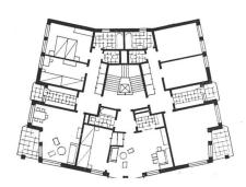
Grundrißskizze für Laubenganghaus 1:400 (5-geschossig) | Croquis de plan d'un immeuble à galeries d'accès | Plan sketch of a building with access galeries
