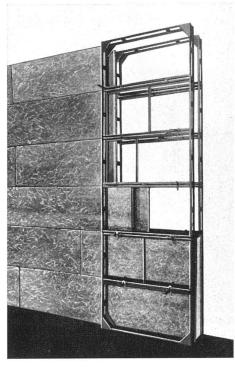
«Beru-Bauweise», Metallhalter für Isolationsplatten, die ausbetoniert we den (Propag, Basel) | Nouveau système de coffrage pour murs en béton Insulation boards held in place by metal frames and filled in with concre
