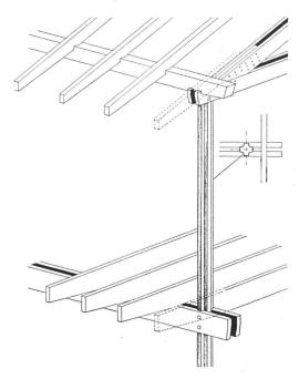
Dachkonstruktionsdetail 1:50. Durchgehende, kreuzförmige Stütze mit Balken- und Sparrenlage | Détail de la construction: poteau en croix et charpente | Construction detail; laminated supports, floor beams and ratters
