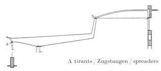
Dispositif du toit de l'aula | Schnitt durch Auladecke | Disposition of the auditorium roof
