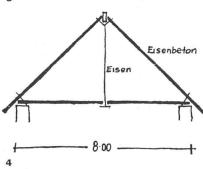
**3-4** Vorfabriziertes Dachgebälk in Eisenbeton
