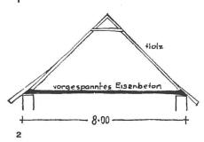
1-2 Vorfabriziertes Dachgebälk in Eisenbeton und Holz
