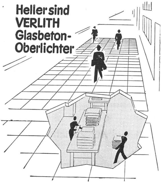
Garantiert wassererdicht. Starke Lichtwirkung. Widerstandsfähig gegen chemische Einflüsse. Keine Rostbildung. Praktisch unverwüstlich und daher geringe Unterhaltskosten.
