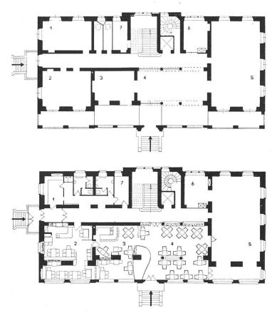
Erdgeschoβ vor und nach dem Umbau 1:300 / Le rez-de-chaussée avant et après la transformation / Groundfloor before and after remodelling
