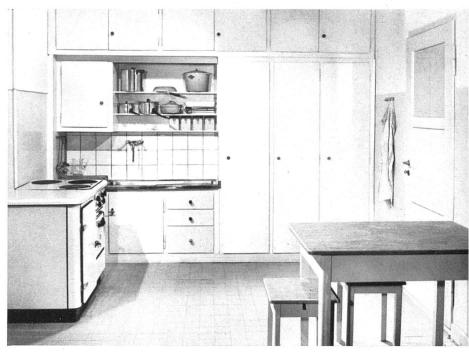
Die vollständig vorfabrizierte Küche kommt wie alle übrigen Wand- und Deckenelemente fer gestrichen auf die Baustelle | La cuisine est entièrement préfabriquée et peinte à l'usine – com tous les éléments de l'intérieur | Like all other internal units, the entirely prefabricated kitcl is finished at the shop
