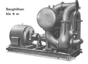
Leistungen 1-500 Liter/Sek. Kein Bodenventil. Keine Klappe im Saugstutzen. Keine Hilfs-Vakuum-Pumpe. Jederzeitiges automatisches Ansaugen auch nach Lufteintritt im Saugrohr. Keine reibenden, sich abnützenden Dichtungsflächen, daher unempfindlich gegen Sand, Schlamm und Kies.
