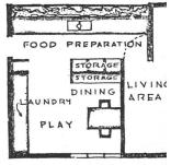
Abb. 20. Der mechanische Hauskern; H-förmiges Haus von J. und N. Fletcher, 1945. Grundriβ (aus Pencil Points) / Le noyau mécanique de la maison; plan en forme de H / The mechanical core; H-shaped house. Plan
