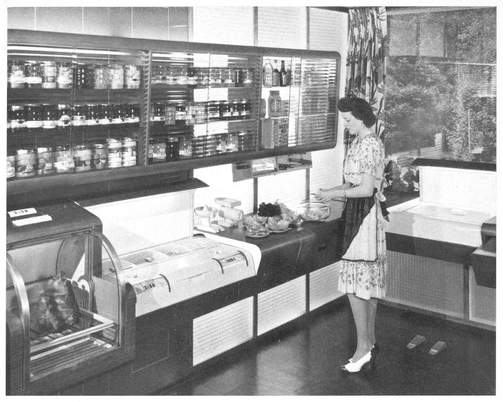
Abb. 10. Elektrische Modellküche mit versenkten, herausnehmbaren Kochtöpfen, 1943. Die Apparate mit Deckeln verschließbar. Backofen und Kühlschrank aus Plexiglas. Libbey, Owens, Ford Glass Co. Entwurf H. Creston Dohner | Cuisine modèle, avec cuisinière électrique à casseroles enfoncées. Tous les appareils ferment à couvercle. Fourneau et frigidaire en verre | Wartime model of electric range with sunken pans. Panels can be lowered over working units. Glass-enclosed oven and refrigerator
