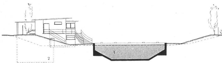
Querschnitt 1:300 mit Schwimmerbecken (1) und Garderobengebäude (2 Filteranlage) | Coupe transversale du bassin et vestiaires | Cross section through the pool, and the cloakroom building
