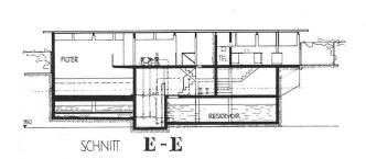
Längsschnitt durch Filtergebäude 1:300 / Coupe du bâtiment de filtrage / Section through filtering plant
