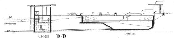
Querschnitt durch Filtergebäude und Nichtschwimmerbecken 1:300 | Coupe transversale du bâtiment de filtre et le bassin pour non-nageurs | Section through filtering plant and pool for non-swimmers
