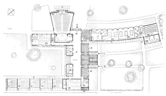
Erdgeschoβ 1:800, links Schüler-, rechts Erwachsenenflügel | Rez-de-chaussée | Ground floor
